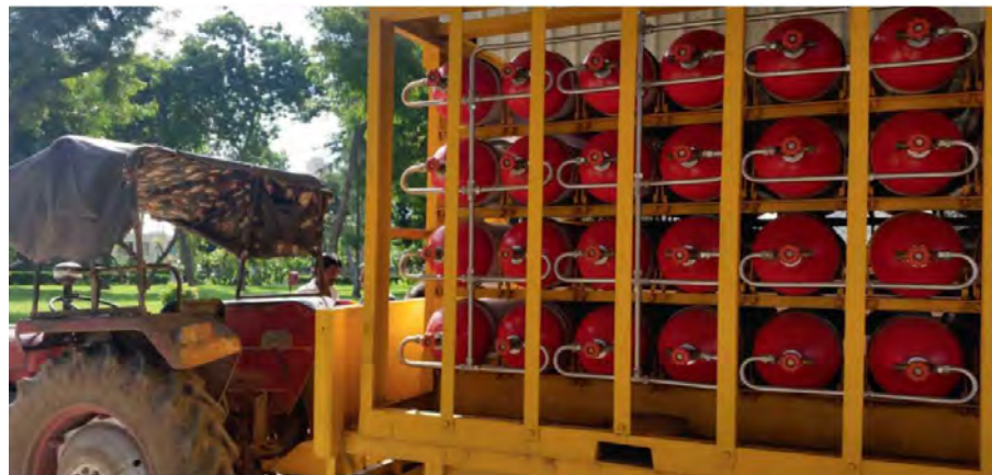
Транспортировка биометана в баллонах для сжатого газа в Индии
