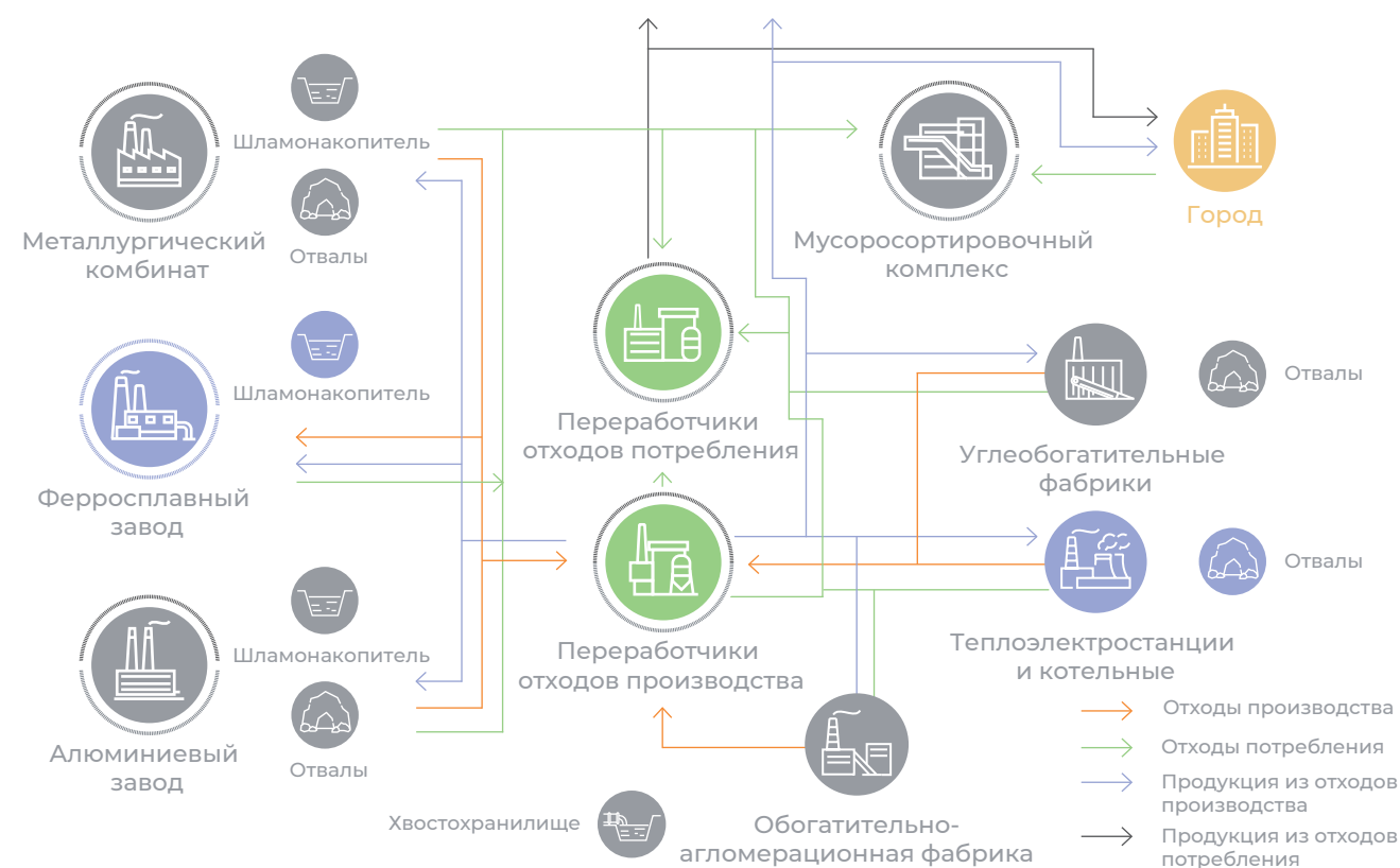
Рис. 2. Потоки отходов и произведенной на их основе продукции в рамках экопромышленного симбиоза в Новокузнецком экотехнопарке
