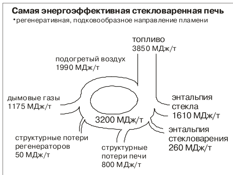
Рисунок 1. Диаграмма Сэнки для самой эффективной стекловаренной печи (регенеративная печь с подковообразным направлением пламени, без предварительного подогрева сырьевых материалов и электроподогрева, приведенная к 50% стеклобоя
