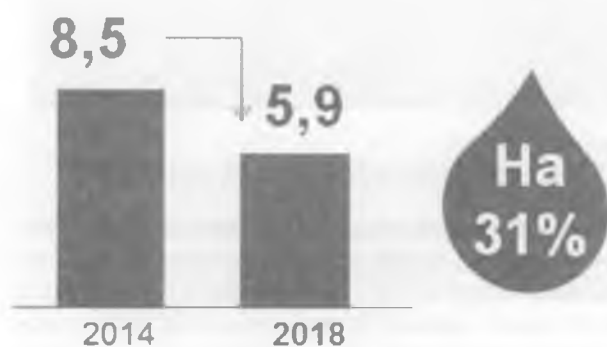
Рис. 6. Общее ожидаемое сокращение сброса МНПЗ загрязняющих веществ со сточными водами, тыс. т. в год
