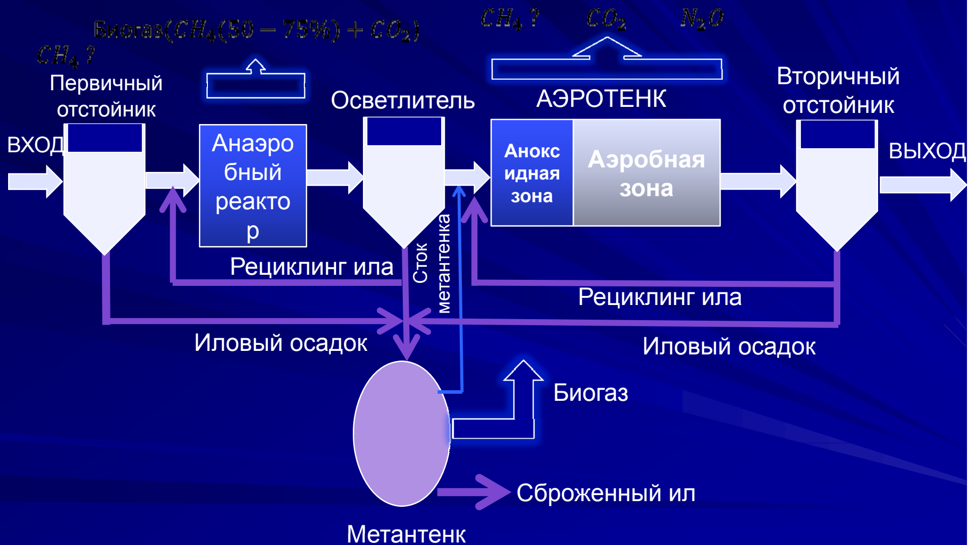
Схема комбинированного процесса очистки сточных вод
