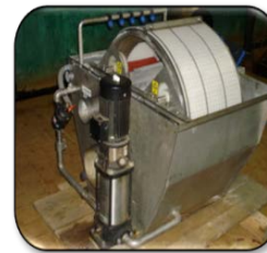
Барабанный сетчатый фильтр (Hydrotech, Швеция)
