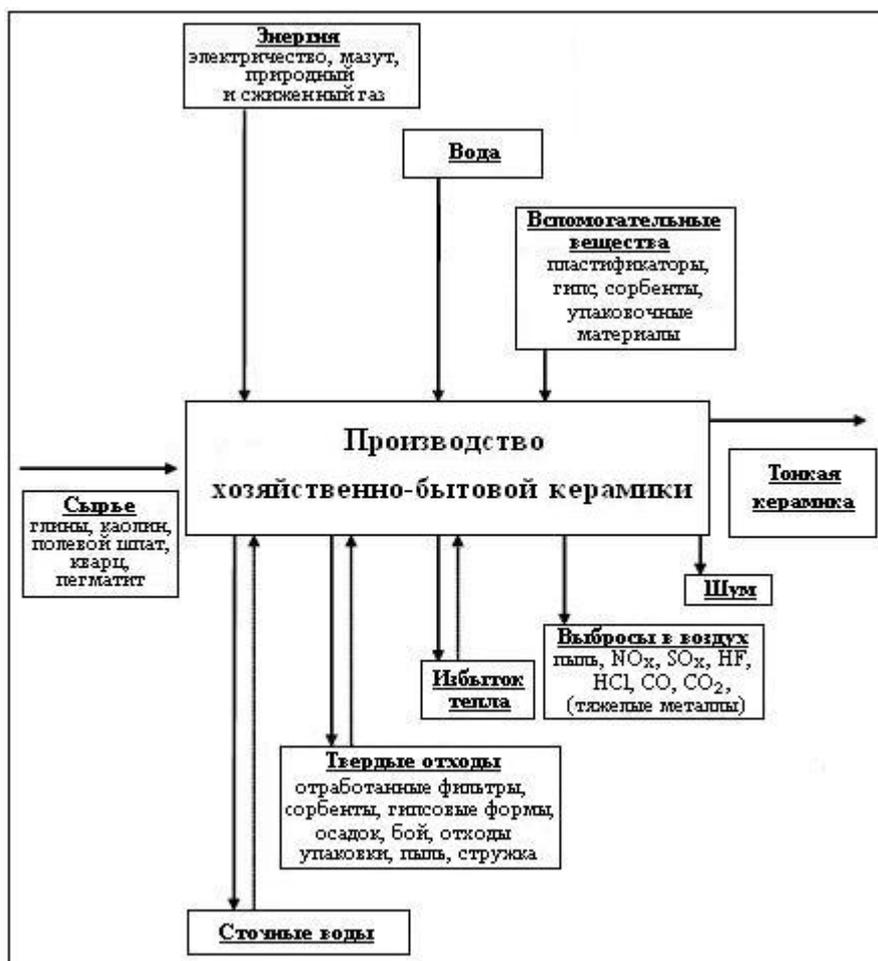
**РИС. 2.23. ВХОДНЫЕ И ВЫХОДНЫЕ ПОТОКИ В ПРОИЗВОДСТВЕ ХОЗЯЙСТВЕННО-БЫТОВОЙ КЕРАМИКИ**
