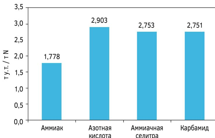
Рис. 13.22. Сравнение производств связанного азота по энергопотреблению
