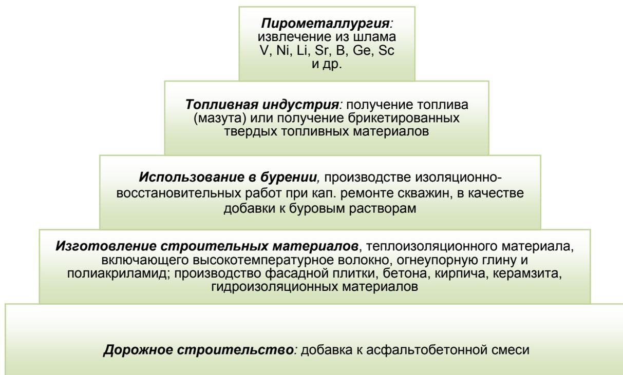
Рис. 17.6. Направления использования нефтешламов и их распространенность
