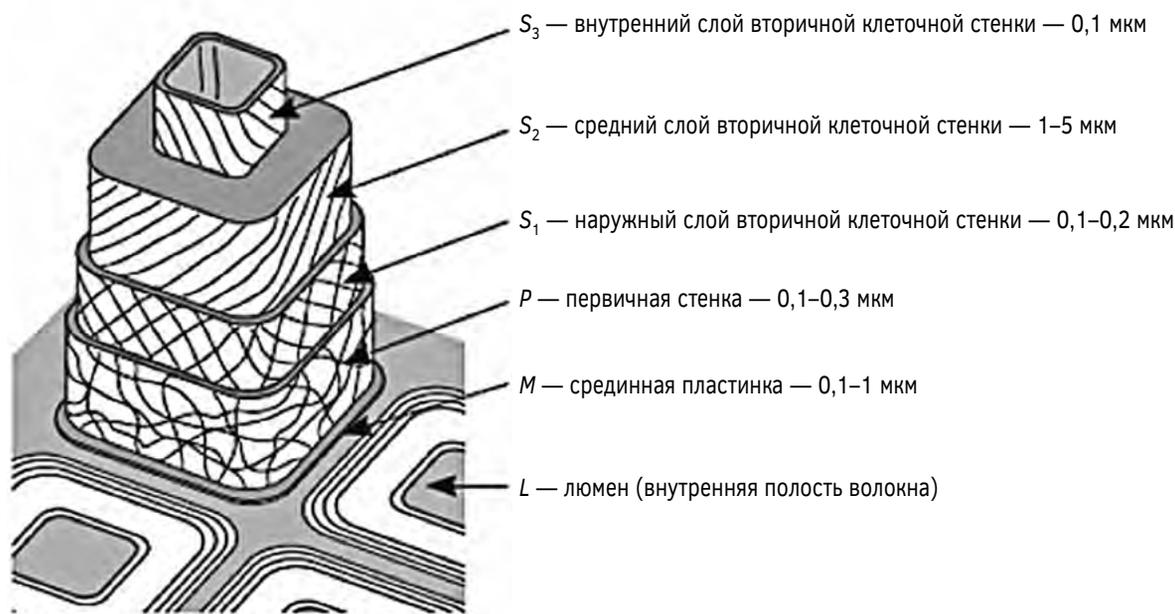
Рис. 14.15. Слоистая структура клеточной стенки
