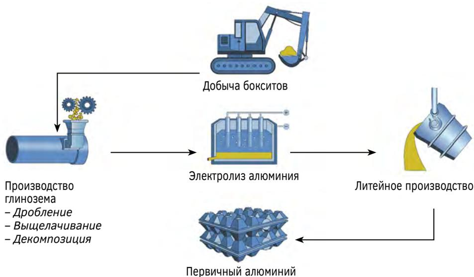
Рис. 9.3. Схема производства первичного алюминия
