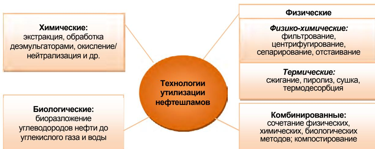
Рис. 17.5. Технологии утилизации нефтешламов
