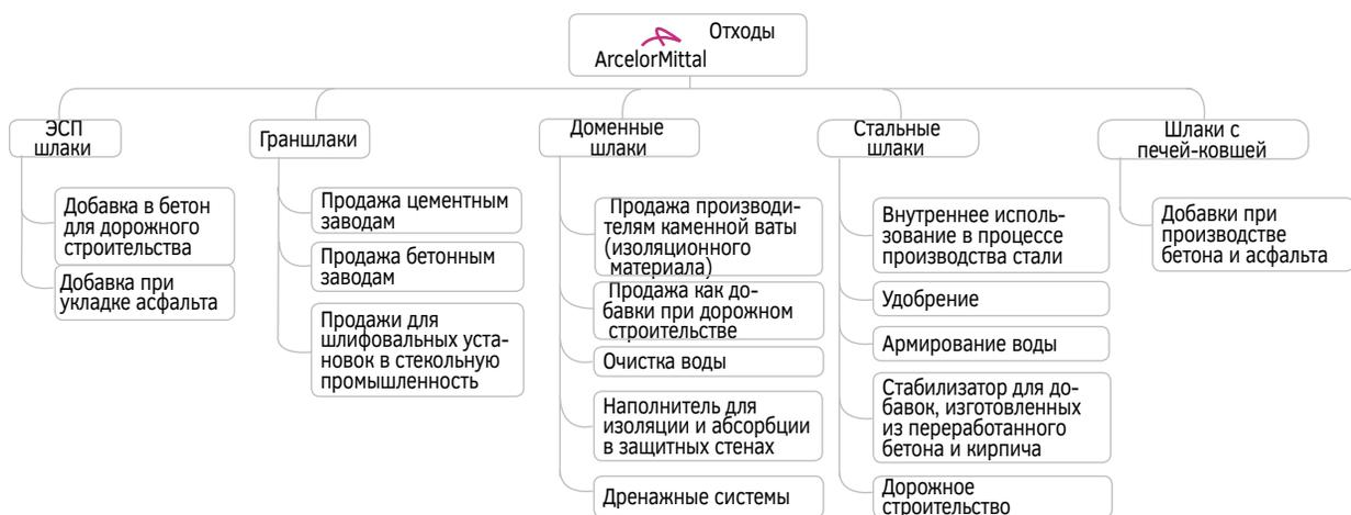
Рис. 18.2. Направления использования металлургических шлаков на заводах компании ArcelorMittal
