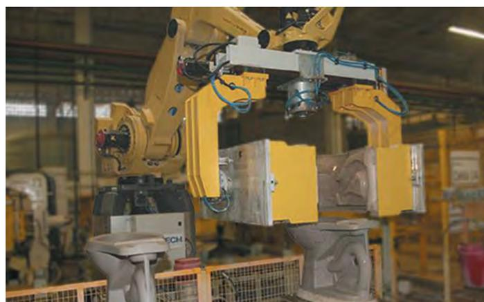
Рис. 10.16. Производство санитарно-керамических изделий: литье под давлением в полимерные формы на прессе-автомате
