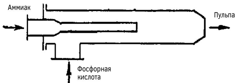
Рис. 13.9. Трубчатый аммонизатор кислот
