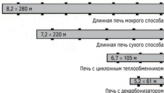
Рис. 12.29. Расчетные размеры вращающейся печи для производства 5000 т клинкера в сутки (по данным журнала ZKG 4/1999)
