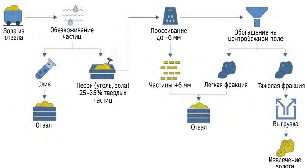
Рис. 15.8. Технологическая схема извлечения золота из ЗШО
