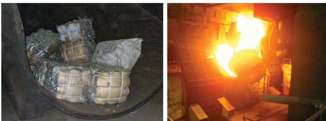
Рис. 18.7. Спрессованные пластмассы в загрузочном совке перед подачей в кислородный конвертер
