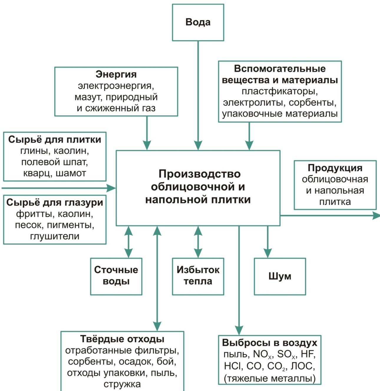
Рис. 2.8 Входные и выходные потоки в производстве керамической плитки [271], с изменениями и уточнениями
