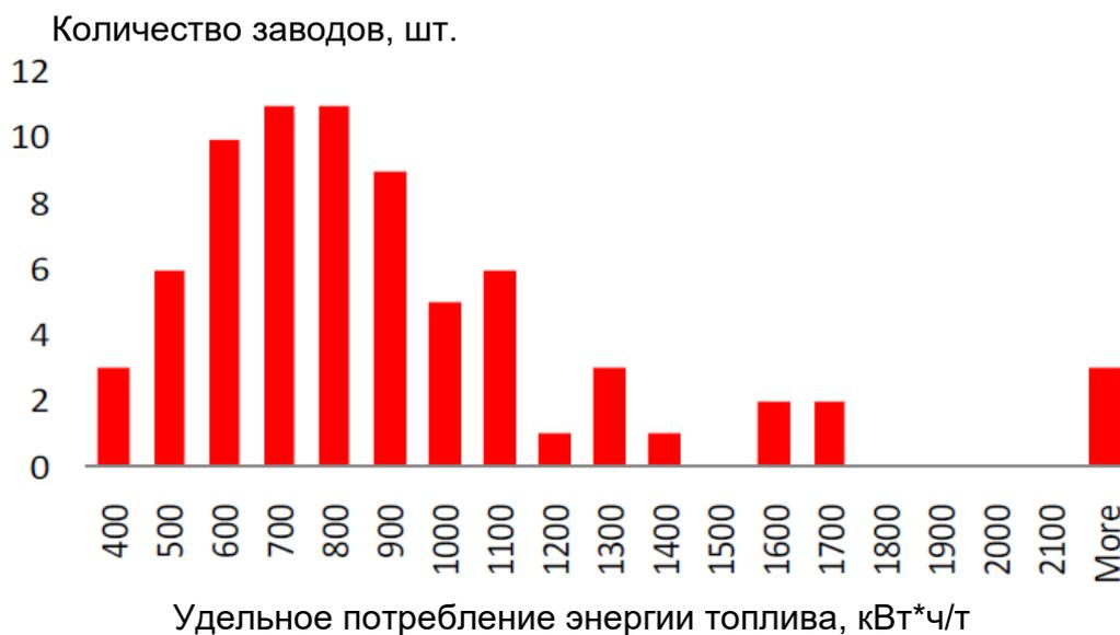
Рис. 3.5 Удельное потребление энергии топлива в производстве кирпича в Великобритании [244]
