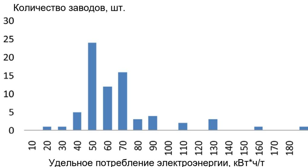
Рис. 3.6 Удельное потребление электроэнергии в производстве кирпича в Великобритании [244]
